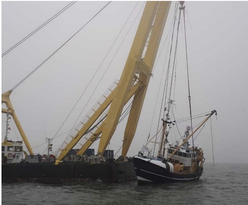
Figuur 8 - Berging van een door een tekort aan stabiliteit gezonken viskotter
