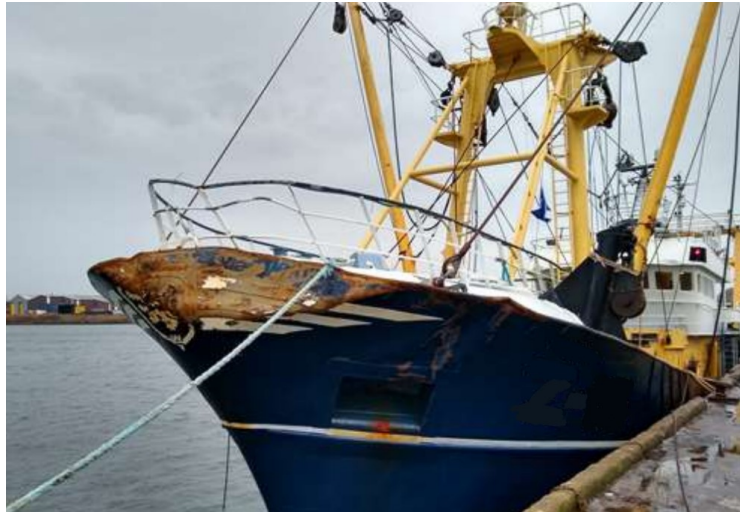
Figuur 4 - Door aanvaring beschadigde viskotter
